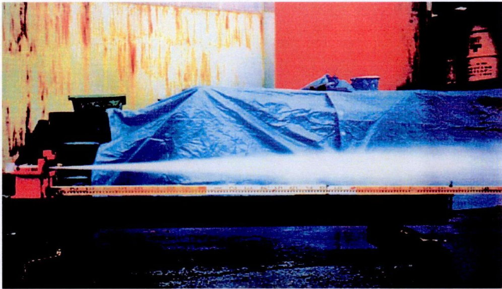
Photo1.1 建設分野で用いるウォータージェットの流動の状況
