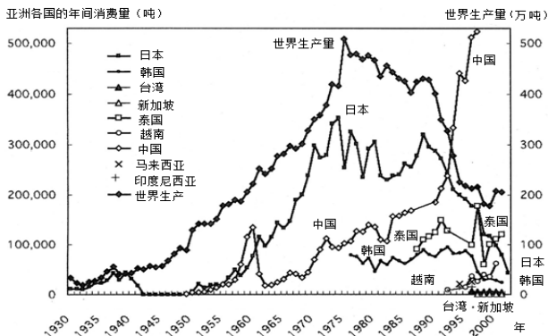
图 2 石棉的世界生产量与亚洲各国消费量的推移 (在 [Furuya et al., 2000] 基础上作部分修改)
