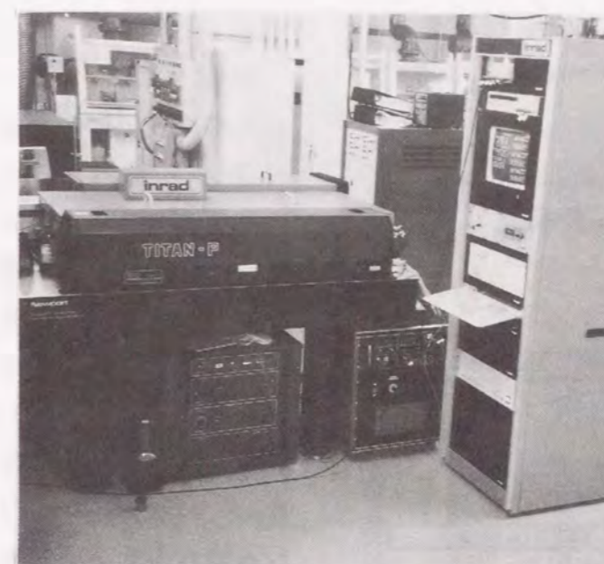
図4-14 可変波長UVレーザーシステムの全体図。
