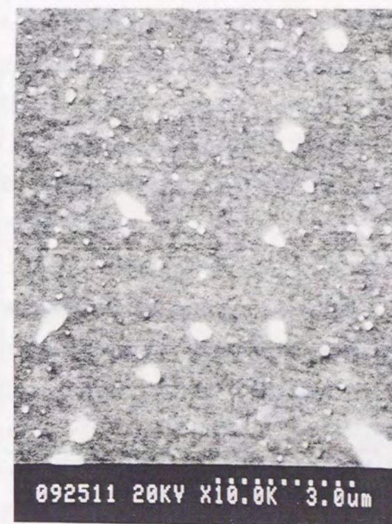
図3.27 Bi2223相薄膜の表面SEM像
