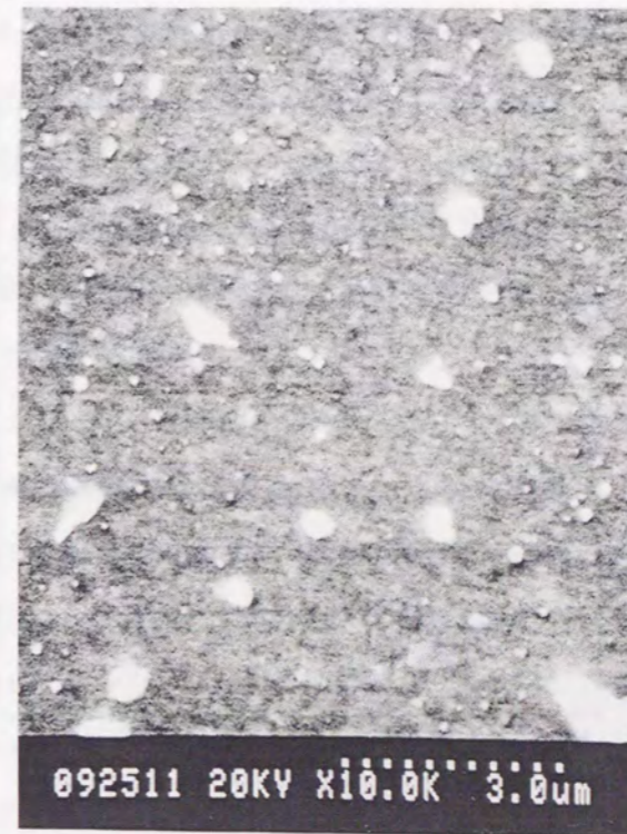
図3.27 Bi2223相薄膜の表面SEM像
