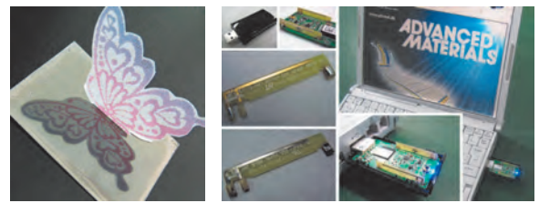
図5 インクジェット重ね塗り印刷によるアンテナの感度向上。
