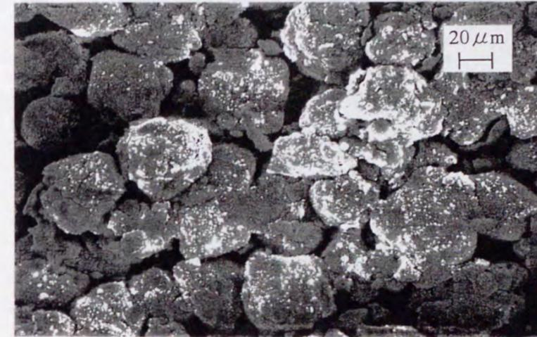
Fig.5-4 焼結体の微構造
