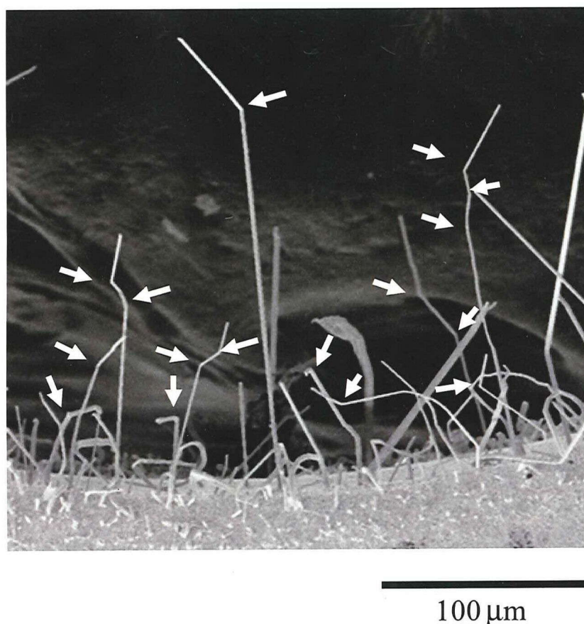
図1-4 機械的応力により発生・成長したSnウィスカのSEM像 (矢印は折れ曲がり部分)
