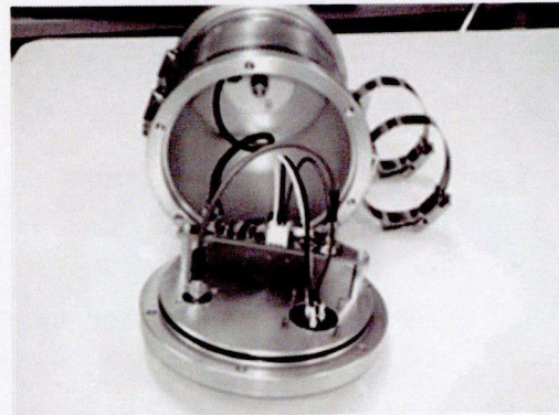
(b)アンテナ筐体内部
