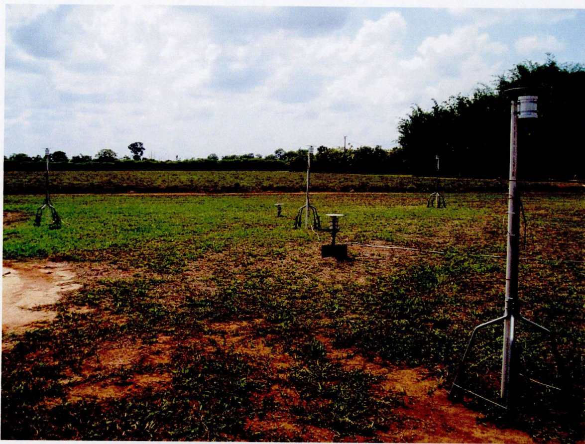
図 3.1: VHF 帯広帯域干渉計の設置写真。
