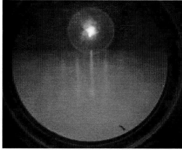
図 7.3 Al 添加 \beta -FeSi 2 の RHEED 像 T_{Al} = 950^\circ\text{C} , \langle 112 \rangle 入射
