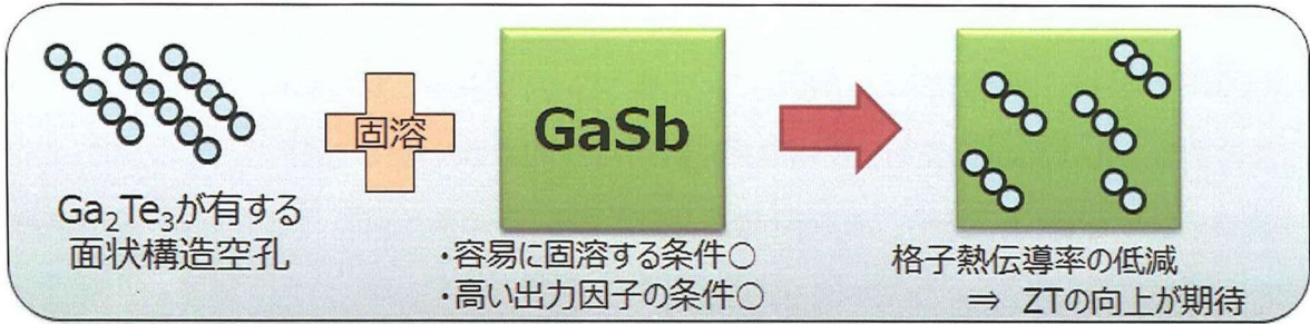
図3.1.固溶による構造空孔導入のイメージ
