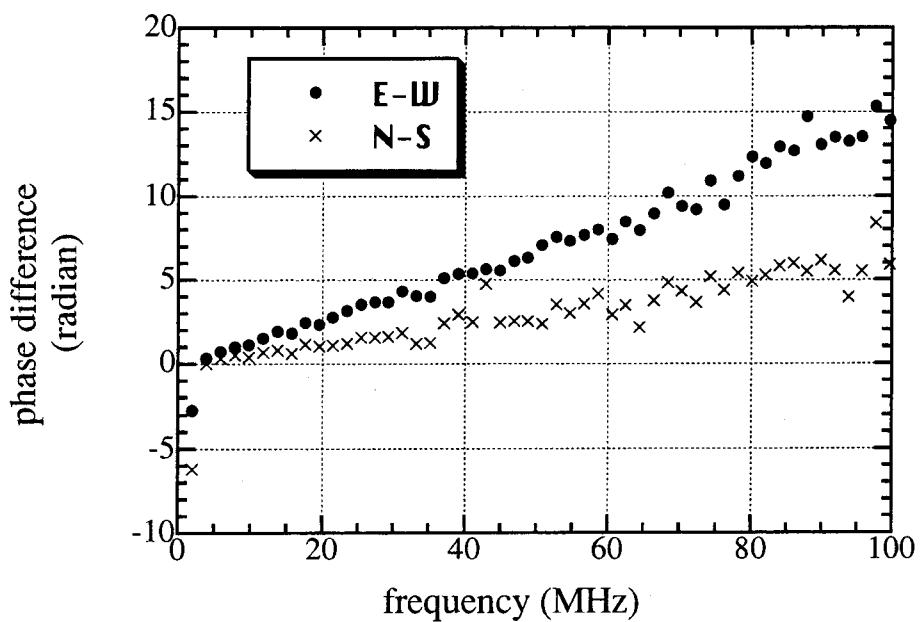
図 4.7 東西、南北方向の各アンテナ対での広帯域信号の位相差（フリンジの選択結果）
