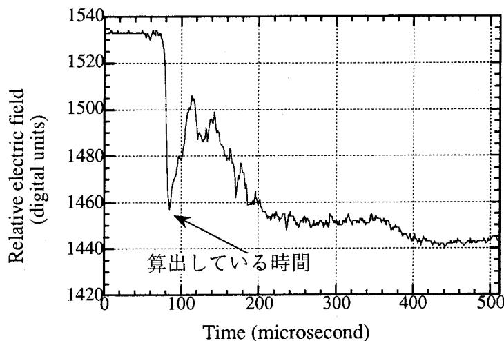
図 3. 2 帰還雷撃部拡大図（5.12 マイクロ秒）
