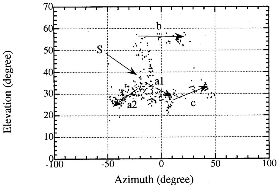
図 5. 4 電磁波放射源の 2 次元標定結果
