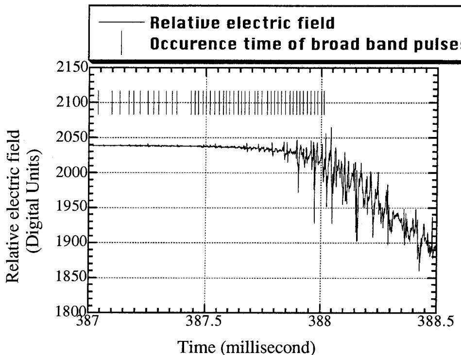
図4. 11 図4. 10の誘雷の放電開始部分の拡大図
