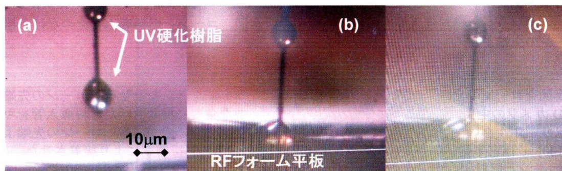
図 3-3 紫外線硬化樹脂を RF フォーム平板に接触させ、浸透するかを試した。紫外線硬化樹脂の RF フォーム平板に接触前(a)、接触直後(b)、接触後 10 分後(c)の各写真。
