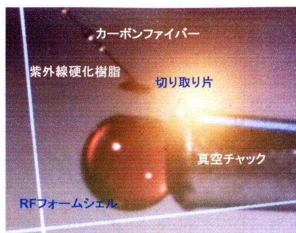
図 2－9 レーザー加工後の RF フォームシェルから切り取り片を取り除いているところの写真。
