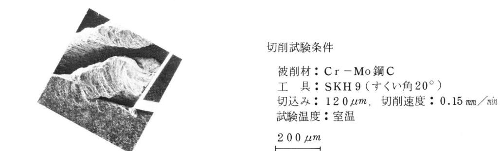
図3-9 Cr-Mo鋼Cにおけるむしれ型
