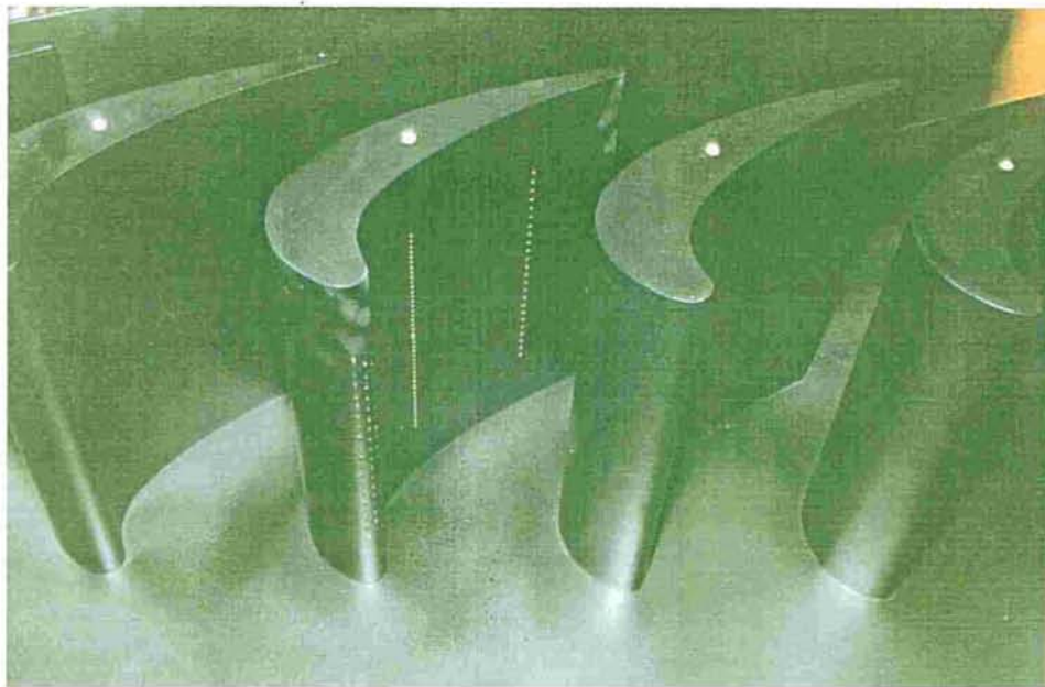
図3.3.2 第1段動翼フィルム冷却効率測定翼モデル
