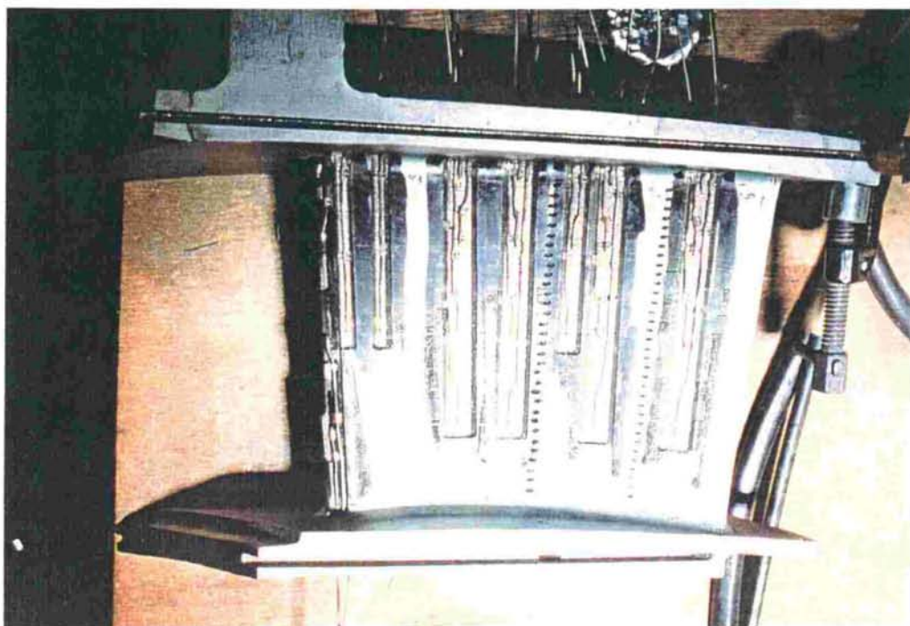
図6.2.6 メタル温度測定翼の熱電対の取付状況 (501D型ガスタービン第1段静翼)
