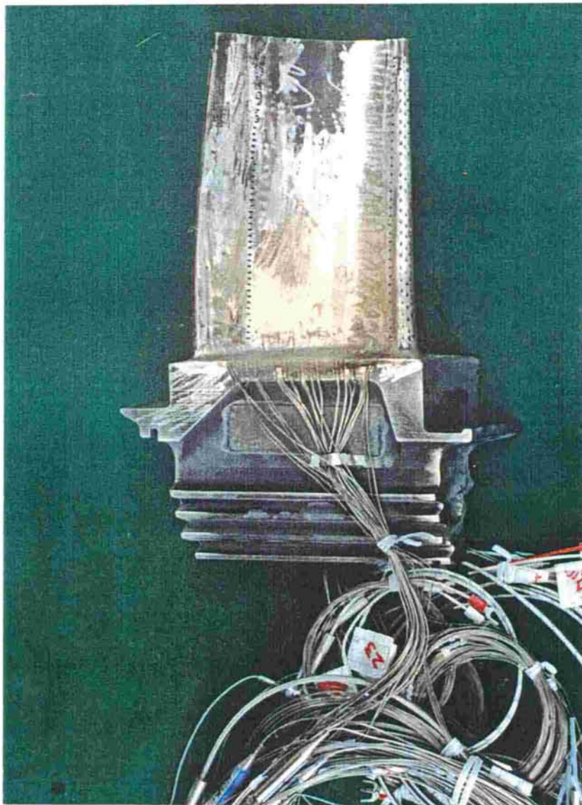
図 6. 2. 19 501F型ガスタービンの第1段動翼高温翼列 実験用供試翼への熱電対取り付け状況
