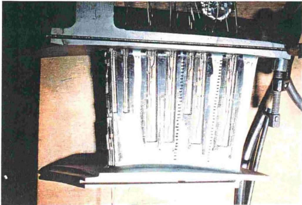
図6.2.6 メタル温度測定翼の熱電対の取付状況
