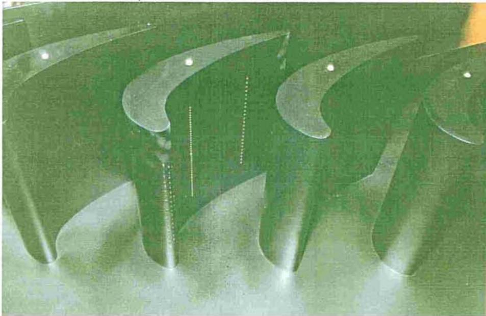
図3.3.2 第1段動翼フィルム冷却効率測定翼モデル
