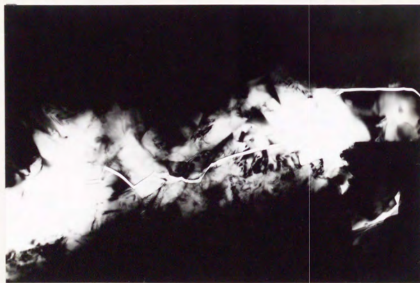
図2-1-15 接合界面のTEM像 (接合温度:1873K, 高温保持時間:1時間, 接合圧力:20MPa, ポリエチレン使用, BN粉末使用, 1気圧窒素ガス雰囲気, 接合面粗さ:0.12 \mu m)
