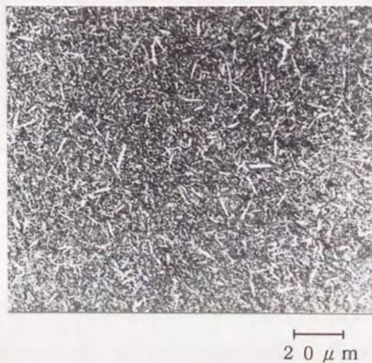
図 2 - 1 - 13 接合不良部分の光学顕微鏡写真 (接合温度:2023K, 高温保持時間:1時間, 接合圧力:30kPa, ポリエチレン使用, 混合粉末使用, 10気圧窒素ガス雰囲気, 接合面粗さ:0.2μm)
