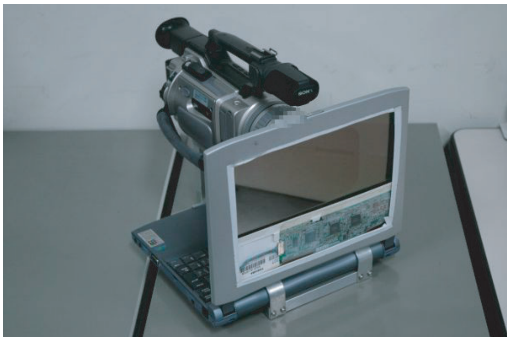
図 4.3: 透過型液晶を用いたシステムの概観 (前面)
