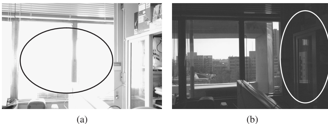
図 2.4: 広い幅の光量を含むシーンの例. (a) 高感度での撮影, (b) 低感度での撮影
