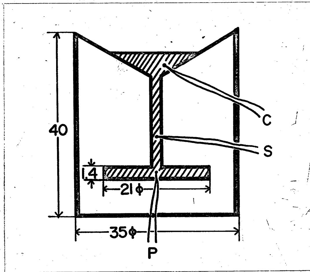
図2 パターンの寸法及び熱電対
