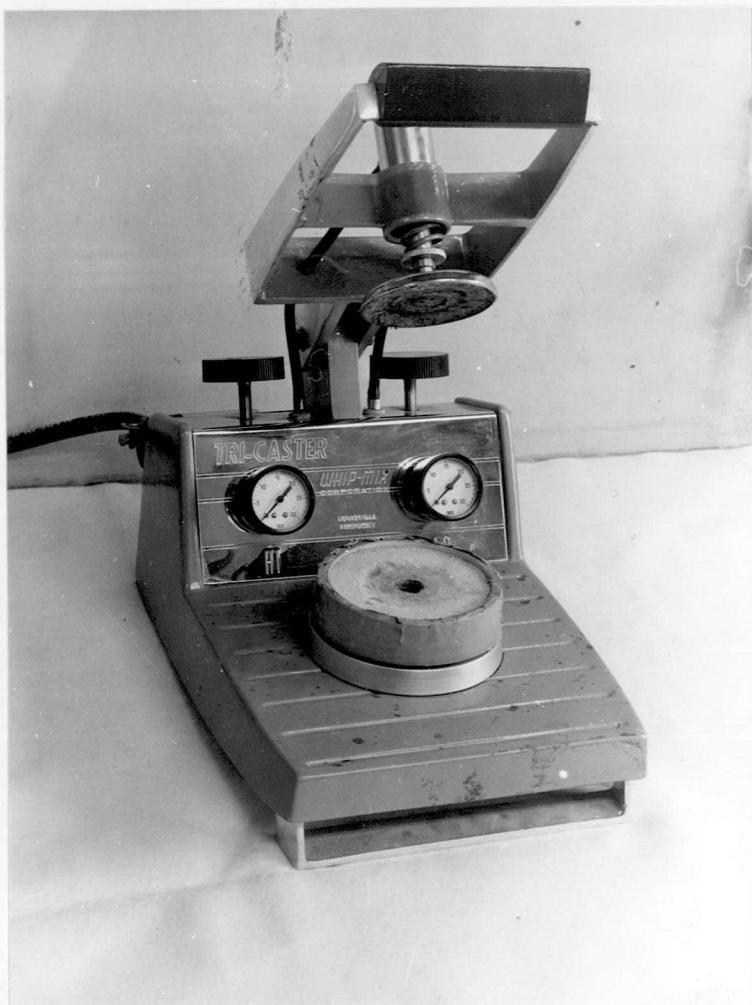
図1 空気圧鑄造機
