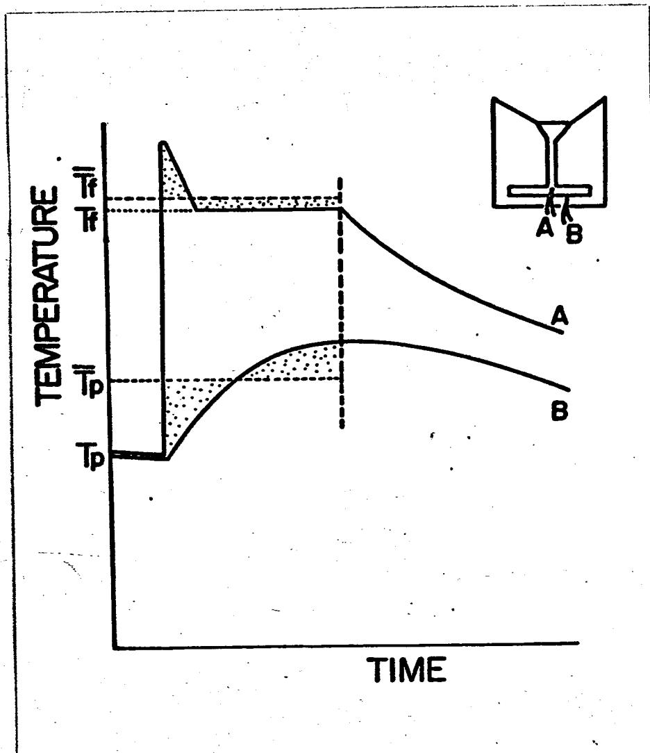
図17. 鋳造時の鋳造体及びパターン壁
