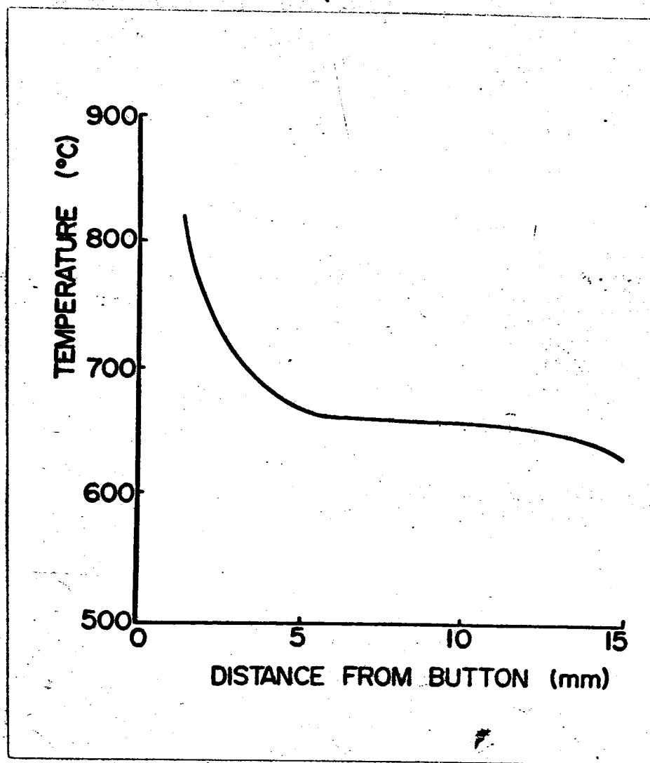
図21. スプル-壁埋没桿の温度上昇
