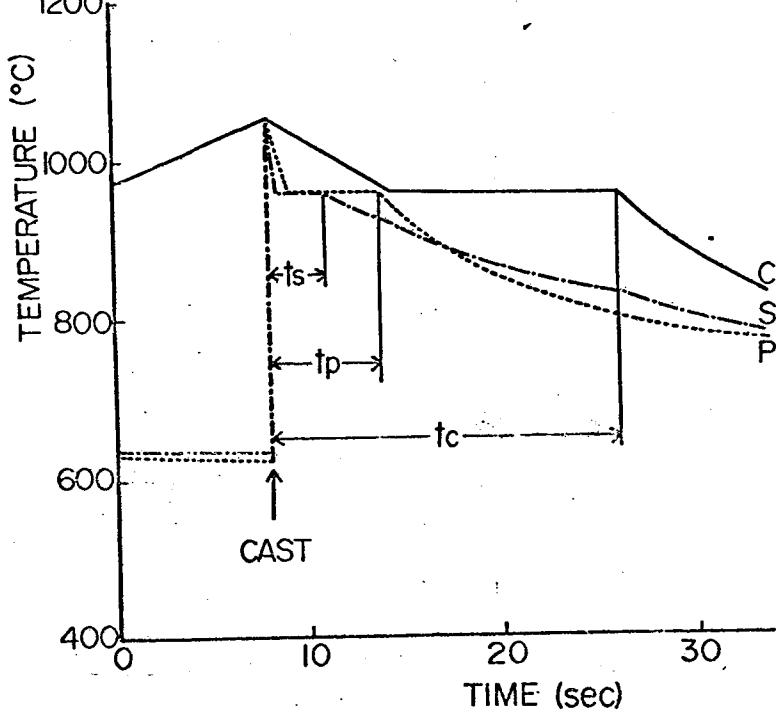
図5 鋳造体各部の温度曲線
