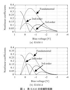
図 4 音 EAM の非線形活致 Fig. 4 Nonlinear coefficients of each EAM.
