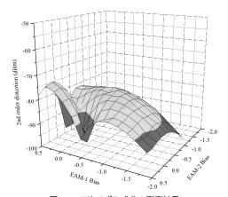
図 13 二次ひずみ成分の測定結果
