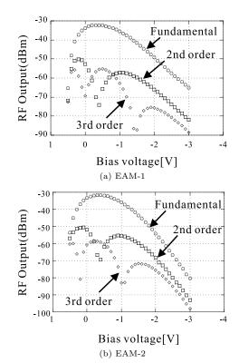
図 5 非線形ひずみの測定結果
