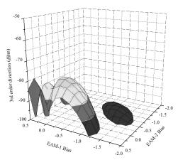
図 14 三次ひずみ成分の測定結果
