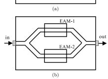
図 6 EAM の直列接続 (a) 及び並列接続 (b) の構成例 Fig. 6 Configuration example of tandem (a) and parallel (b) EAM.
