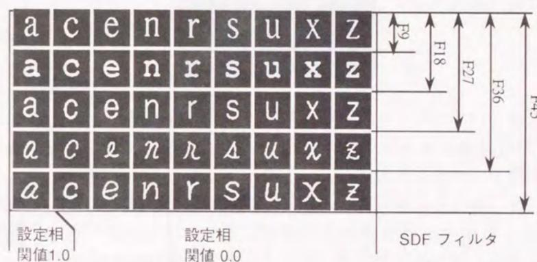
Fig.2-2 SDF を計算するのに用いたトレーニングセット
