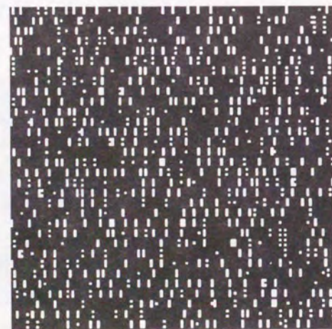
Fig.3-13 設計した簡易型 binary phase-detour 型 CGH (位相、振幅4階調)
