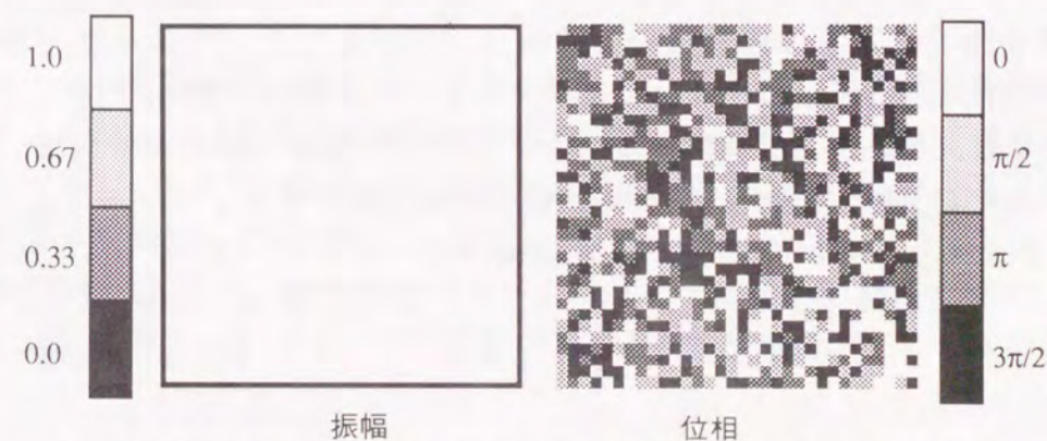
Fig.3-19 設計した CGH のフィルタ関数の振幅と位相の分布 (位相4階調)
