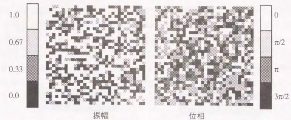
Fig.3-14 設計したCGHのフィルタ関数の振幅と位相の分布 (振幅、位相4階調)
