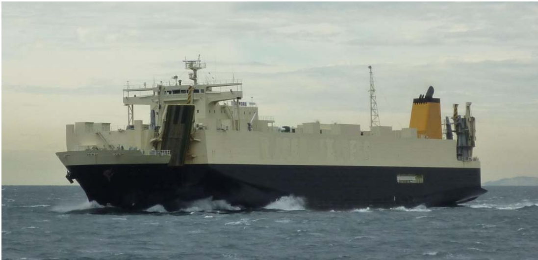
Fig. 4-9 船首船橋型の全長 100m 程度の船舶例
