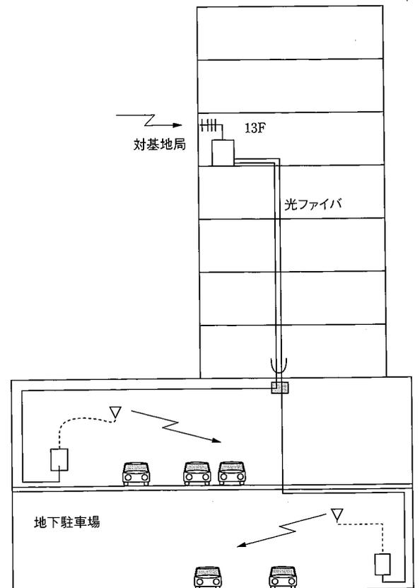
図2 移动通信への適用例
