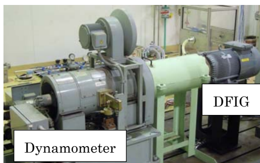
図 4.38 直流動力計と DFIG が結合された実験装置の外観
