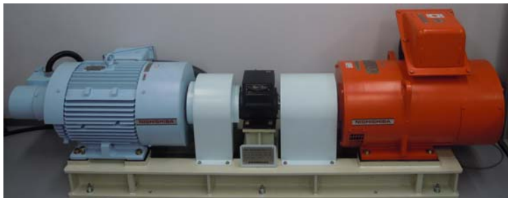
図 6.10 導入された MG セット（左が駆動用誘導機、右が DFIG）
