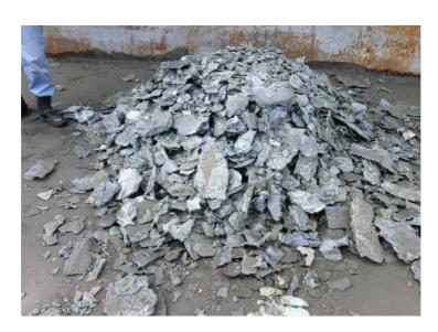
Fig. 4-23. Solidified slag in pit.
