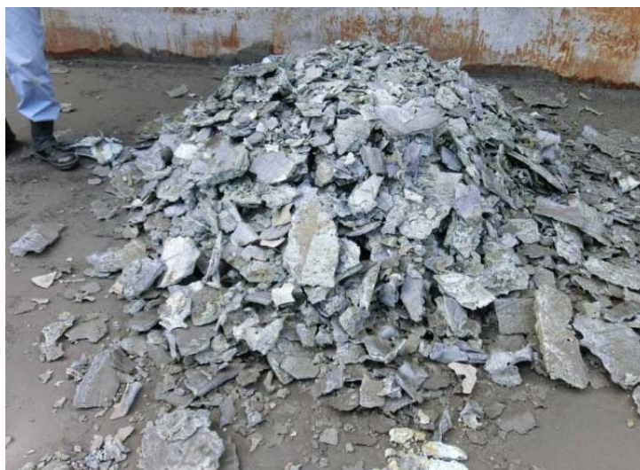
Fig. 4-23. Solidified slag in pit.
