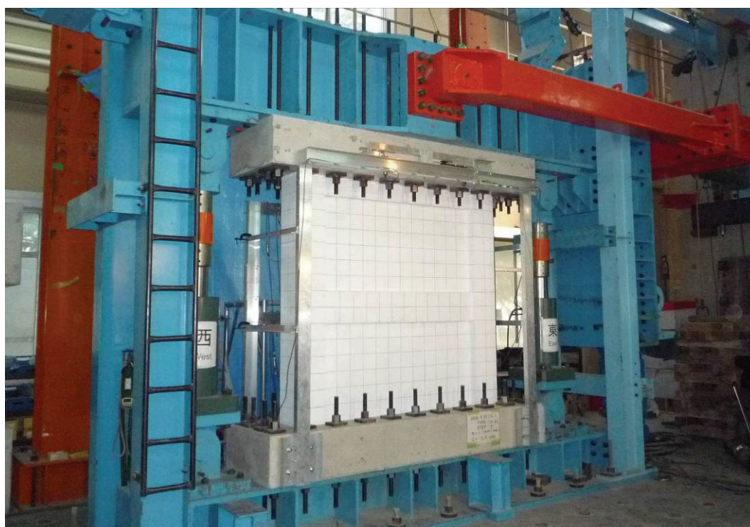
写真 6.2.1 試験体設置状況
