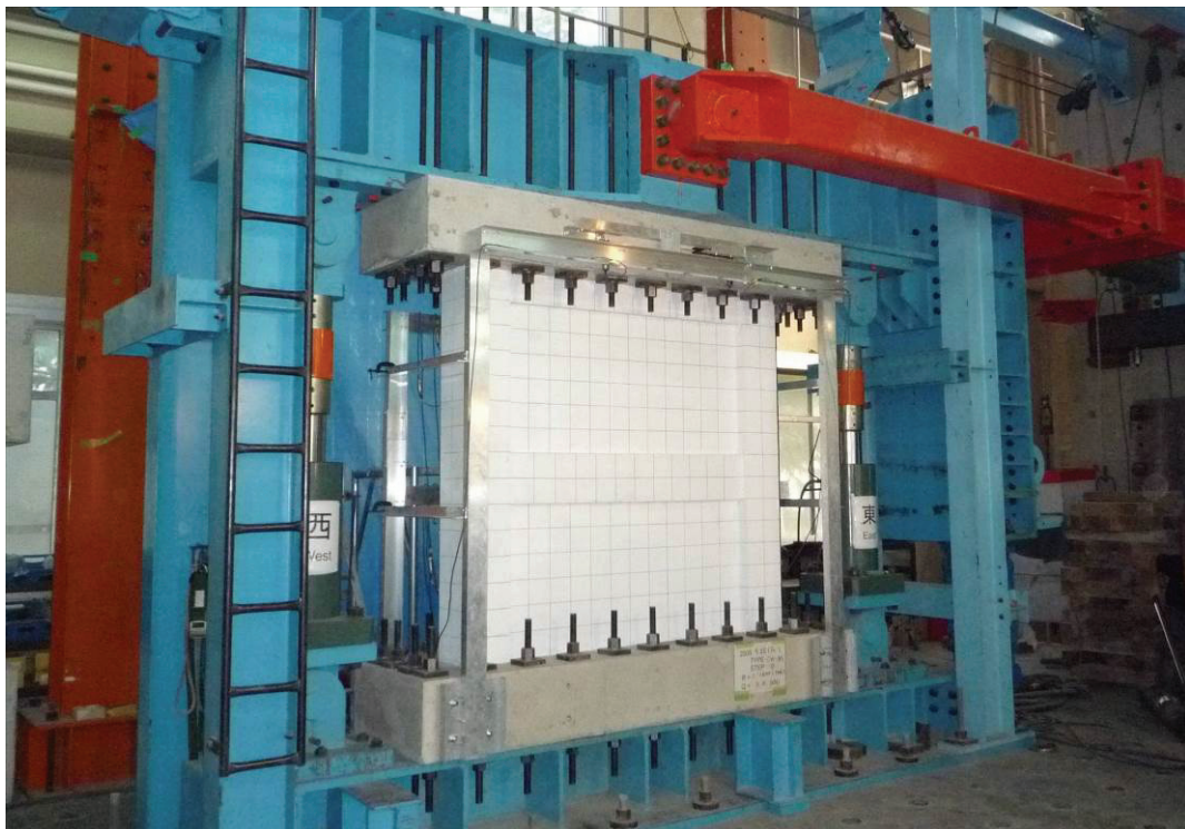
写真 2.2.1 試験体設置状況
