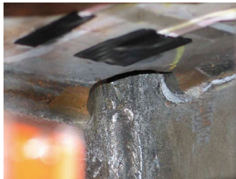
写真-2.2.5 スカラップまわし溶接部止端 の割れ (試験体 3, -3δ y )
