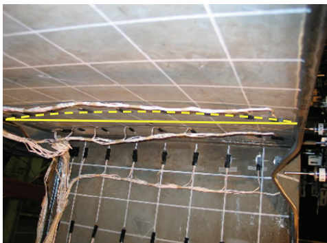
(a) はり下フランジの面外座屈 （試験体 1，終了後）
