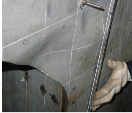
写真-3.4.1 正負交番载荷実験におけるフィレットの面外変形の状態（実験終了後）
