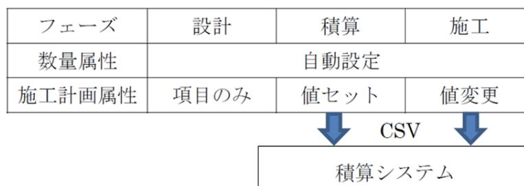
図-5.7 三次元プロダクトモデルと積算システムの連携
