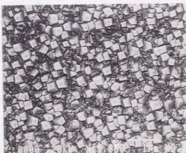
図5.2 ダイヤモンド薄膜の表面SEM像。バイアス処理後1時間の成長を行った。
