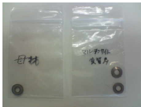
図 4.12 リング状に切り出した試験片
