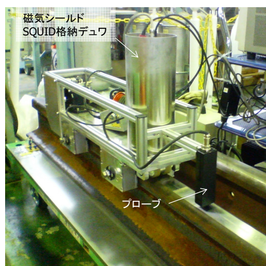
図 7.12 レール走行装置-SQUID および検査プローブ
