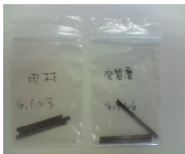
図 4.10 短冊状に切り出した試験片
