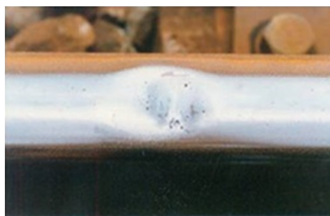
図 3.2 シェリングの例(レール表面) [13]
