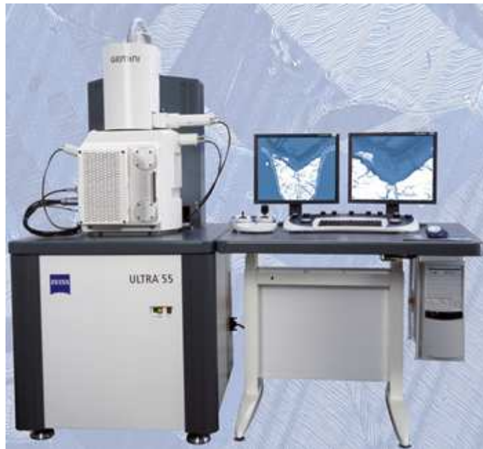
図 2.11 SEM/装置(Carl Zeiss 社製 ULTRA 55)の外観図
