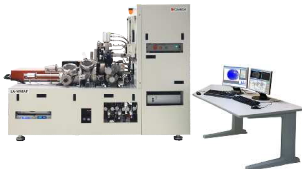
図4.5 アトムプローブ装置外観図 (AMETEK/CAMECA社製レーザアシスト型アトムプローブ Laser-Assisted-WATAP)
