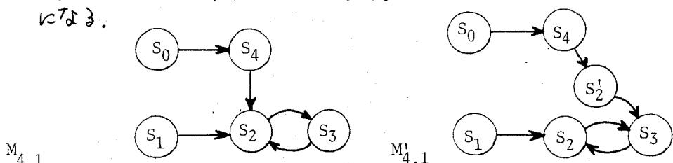
図 6.2 列部分機械  $M_{4,1}$  と状態の splitting
