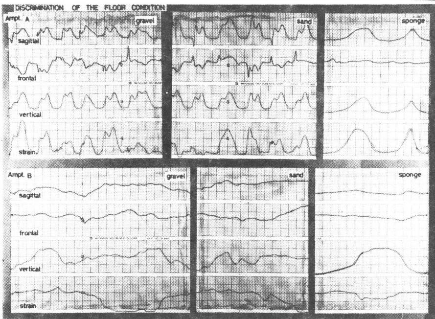
第 3.2 3 図 地面状態識別中の振動歪波形（砂利、砂、スポンジ）
