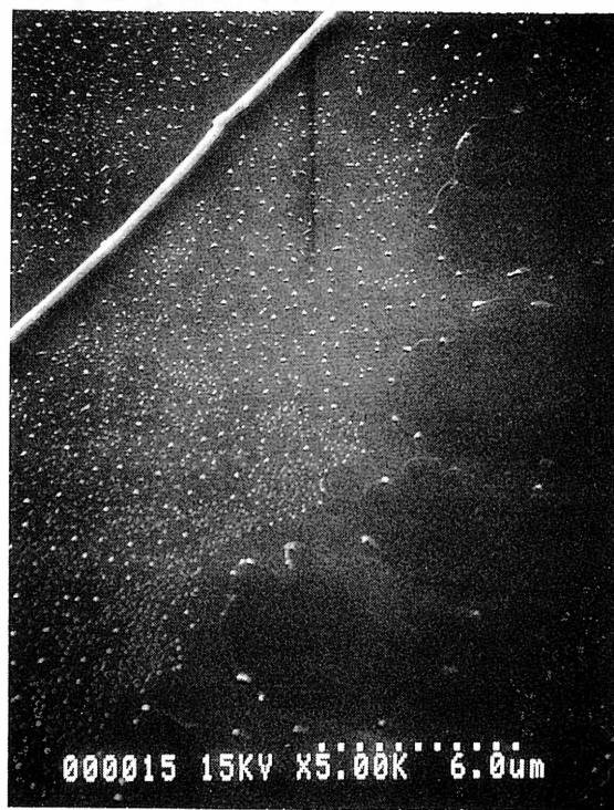
図2-10 水蒸気の下で加熱したSF 4 ガラス 表面のSEM像
