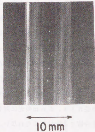
図3. 10 TEGaを封入した石英管へのレーザー照射実験 (室温、レーザー強度500mW、レーザー波長514.5nm、TEGa圧力10torr)
