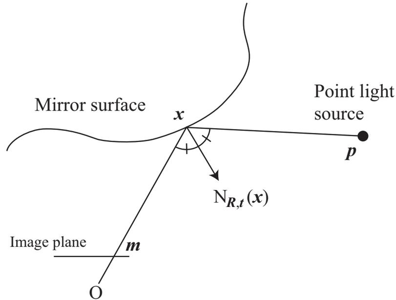
図 2.1: 点光源から反射屈折撮像系への射影
