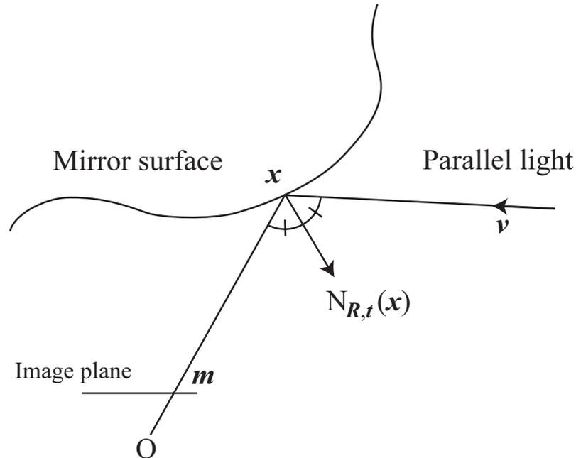
図 2.2: 平行光源から反射屈折撮像系への射影
