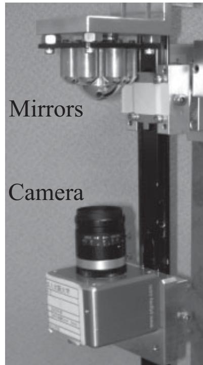
図 4.9: カメラに装着した複合放物面鏡 .
