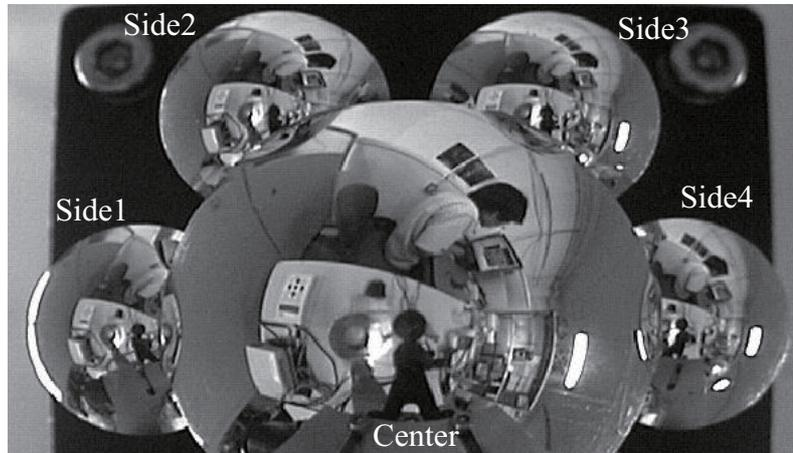
図 4.10: 複合放物面鏡を用いた画像例 .
