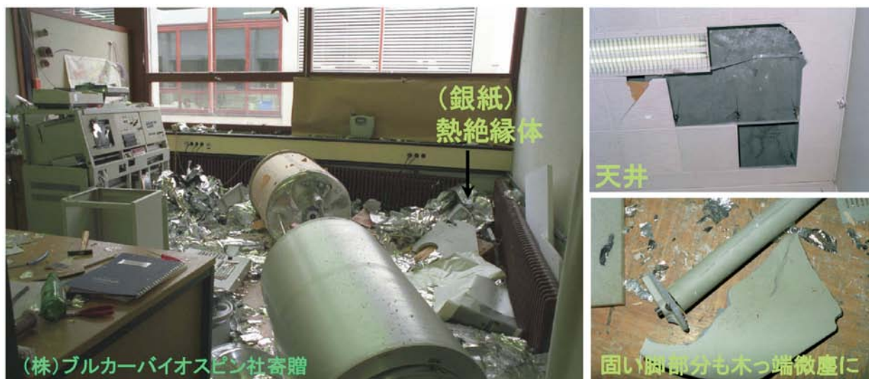
図4 1985年 スイスで夜中に起こった 600MHz NMR 磁石の爆発現場
