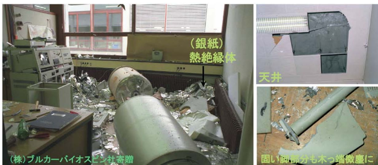
図4 1985年 スイスで夜中に起こった 600MHz NMR 磁石の爆発現場
