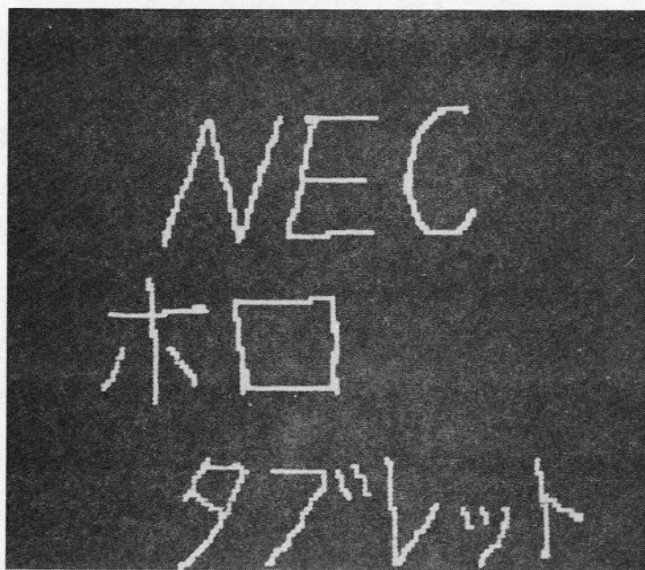
第3.7図 試作した図形入力装置からの出力信号をモニタ用のCRTに表示したモニタ例の写真。
