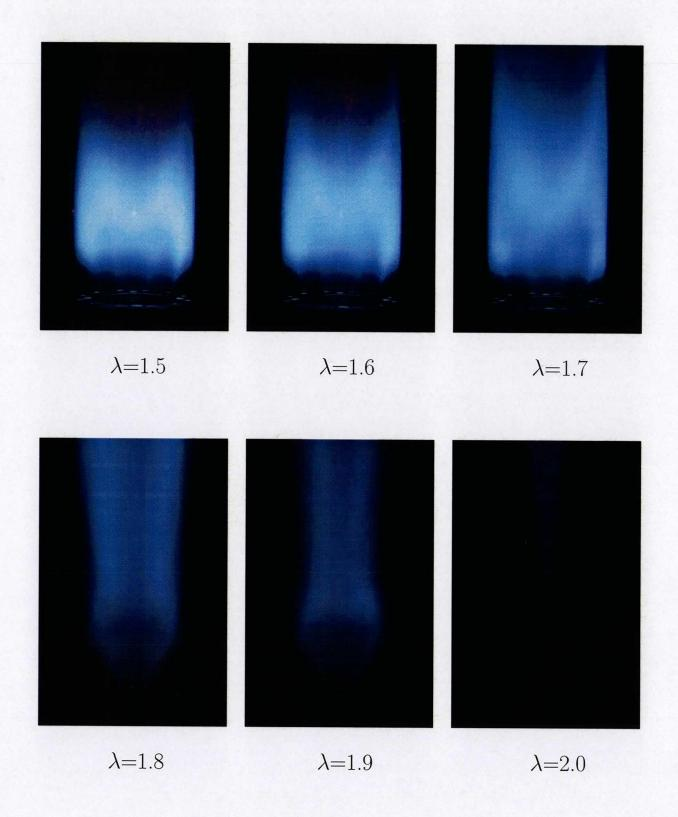
図 2.18: 火炎の直接写真  $(Q_f=10[Nl/min])$
