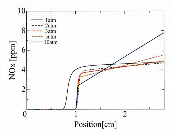
図 5.21: 圧力の変化に伴う NOx 生成量の変化
