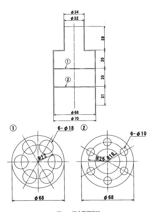
図 2.6: 混合管概略図
