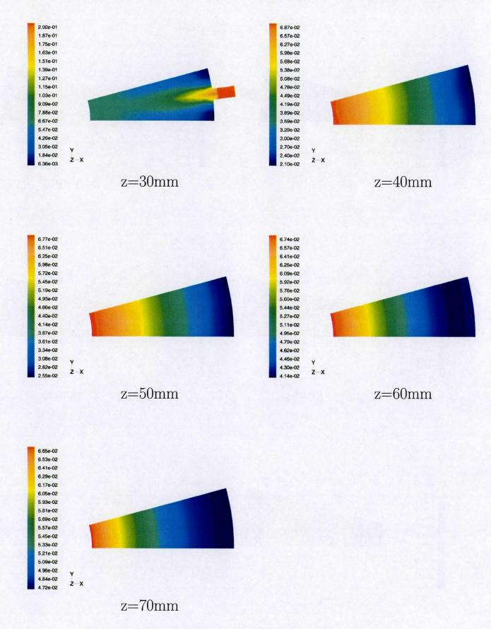
図 4.12: 断面での混合状況 (Q\_f=10[Nl/min],  $\lambda = 1.5$ ,  $\lambda_p = 0.4)$
