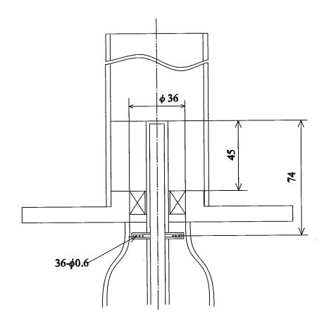
図 2.10: Case2 燃焼器の概略図
