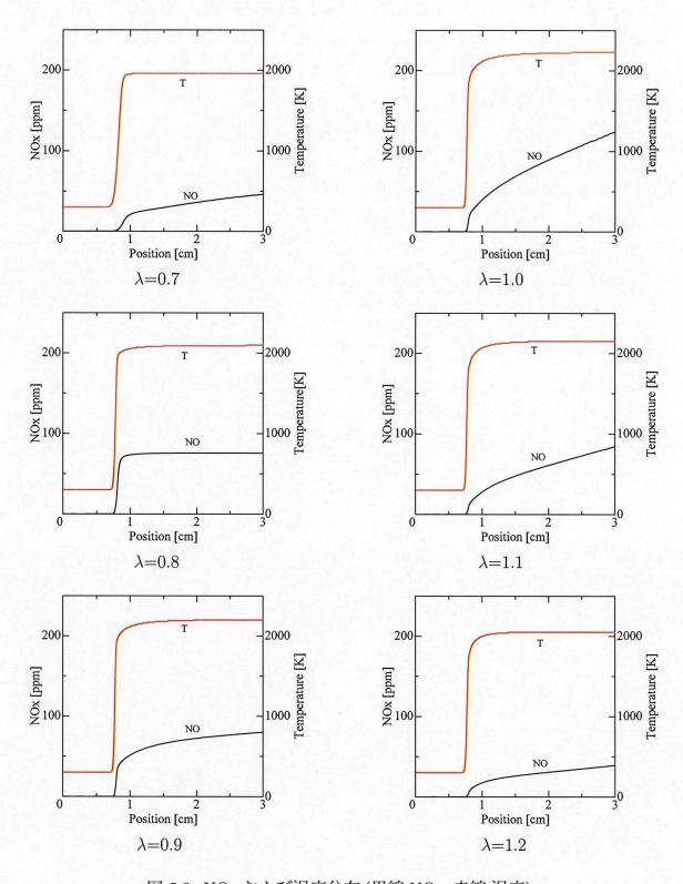
図 5.9: NOx および温度分布 (黒線:NO, 赤線:温度)
