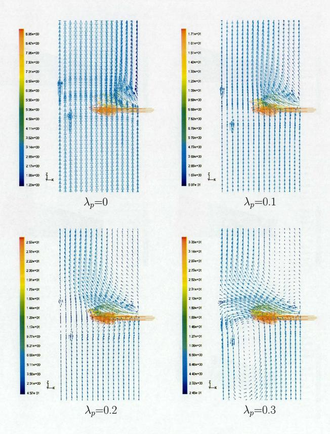
図 4.9: ノズル周辺の速度分布 ( $Q_f=10[Nl/min]$ ,  $\lambda=1.5$ )
