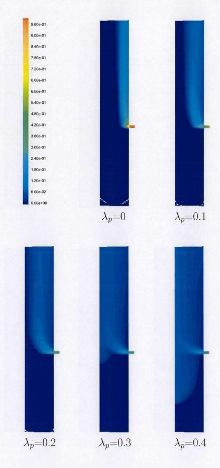
図 4.14: 燃料の混合状況 ( $Q_f=10[Nl/min]$ ,  $\lambda=1.7$ )
