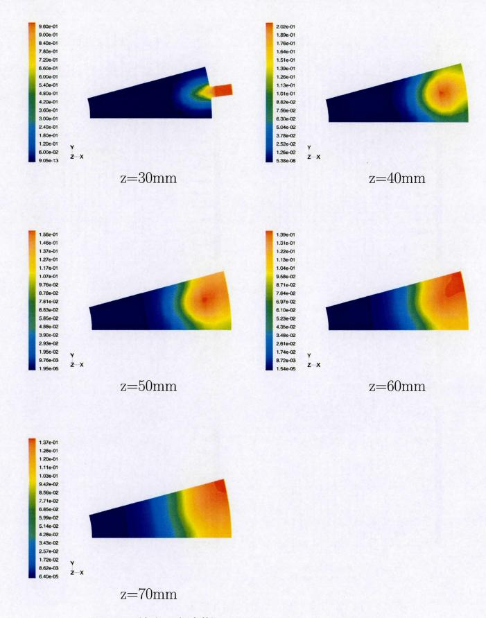
図 4.10: 断面での混合状況 (Q\_f=10[Nl/min],  $\lambda$ =1.5,  $\lambda_p$ =0)
