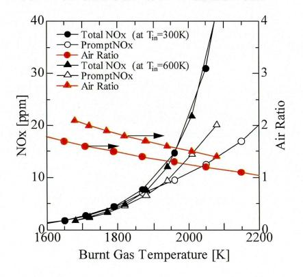
図 5.23: 空気比の変化に伴う NOx 排出濃度の変化
