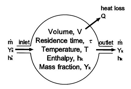
図 5.1: Well-Stirred Reactor の模式図
