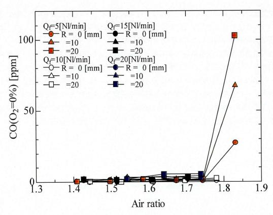
図 2.43: 完全予混合燃焼器 (スワーラなし) における CO 排出濃度
