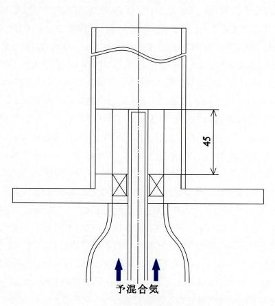
図 2.31: 完全予混合燃焼器の概略図
