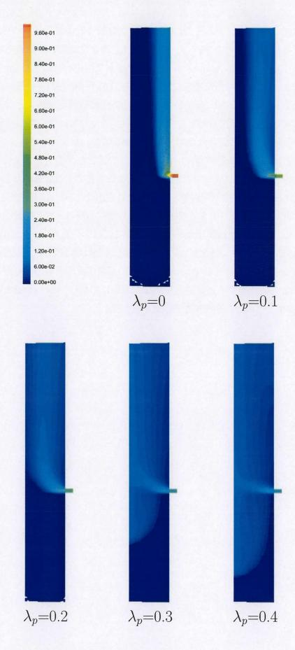
図 4.8: 燃料の混合状況 ( $Q_f=10[Nl/min]$ ,  $\lambda=1.5$ )
