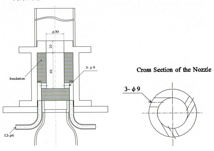
図 2.38: 完全予混合燃焼器 (スワーラなし) の概略図
