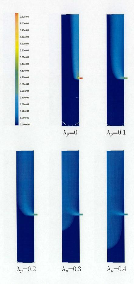
図 4.13: 燃料の混合状況 ( $Q_f=10[Nl/min]$ ,  $\lambda=1.6$ )
