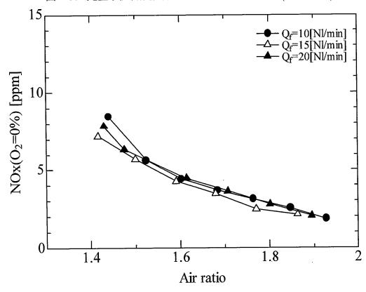
図 2.36: 完全予混合燃焼器における NOx 排出濃度 (燃料:CH<sub>4</sub>)
