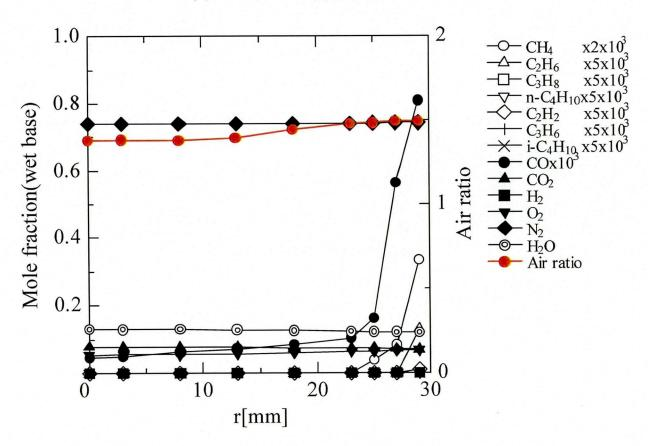
図 3.6: z=100mm 断面の濃度分布
