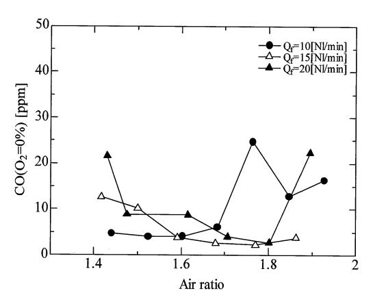
図 2.37: 完全予混合燃焼器における CO 排出濃度 (燃料:CH<sub>4</sub>)
