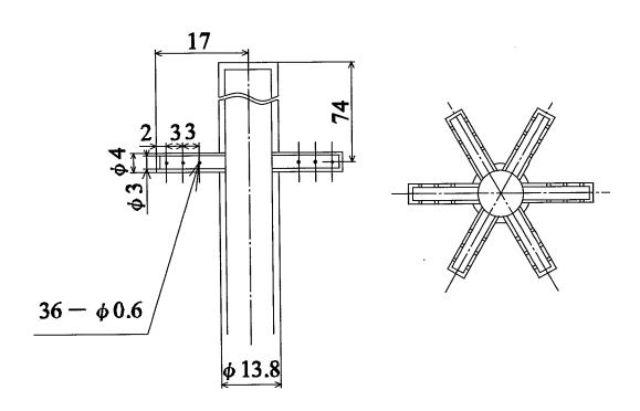
図 2.11: Case2 の燃料ノズル
