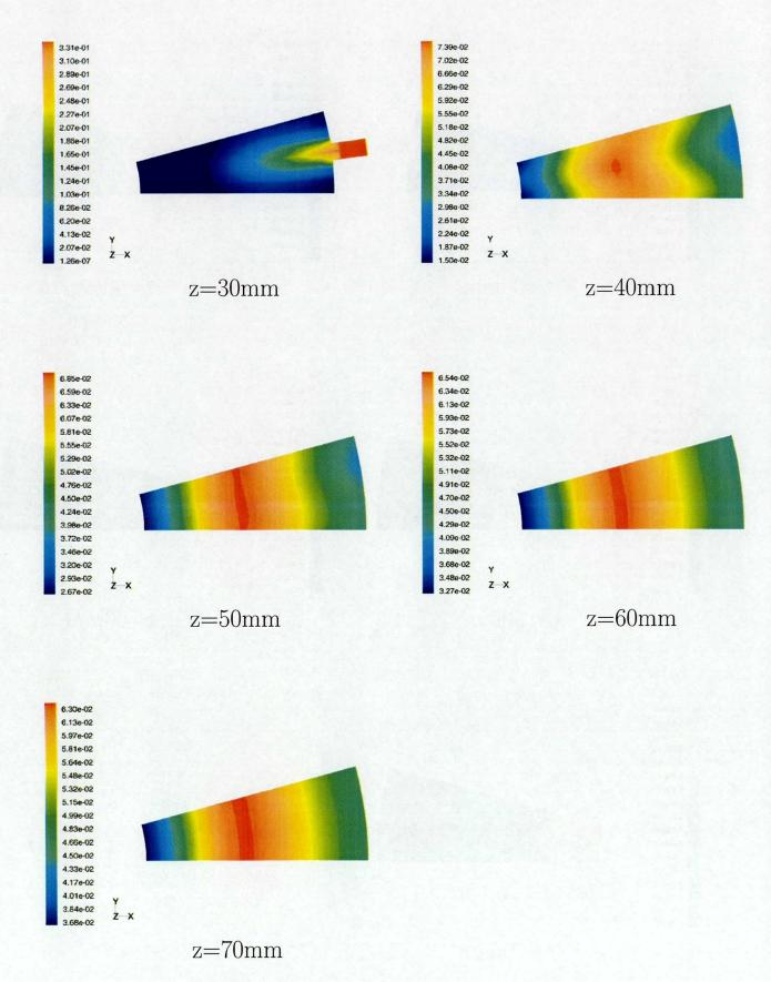
図 4.11: 断面での混合状況 ( $Q_f=10[Nl/min]$ ,  $\lambda=1.5$ ,  $\lambda_p=0.2$ )
