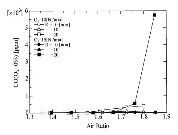
図 2.24: Case3 における CO 排出濃度 (中心側の噴射孔を閉じた場合)
