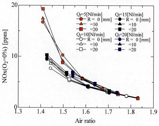
図 2.42: 完全予混合燃焼器 (スワーラなし) における NOx 排出濃度
