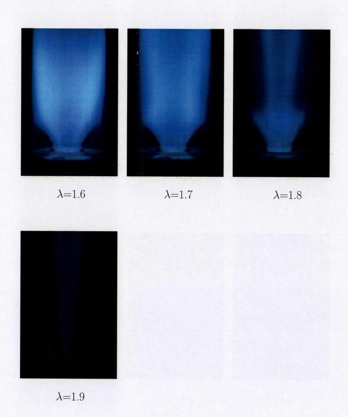
図 2.40: 火炎の直接写真  $(Q_f=20[Nl/min])$
