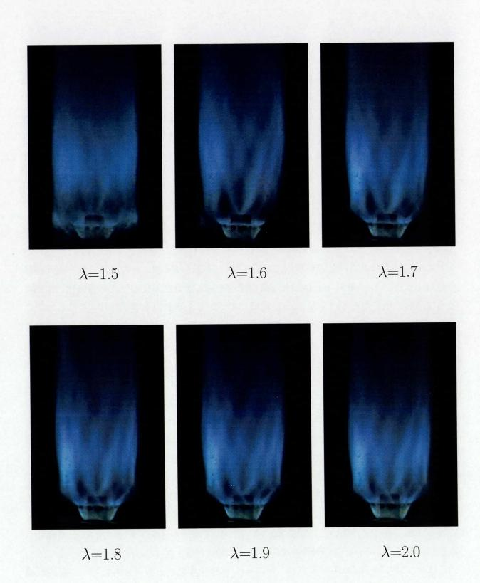
図 2.5: 火炎の直接写真  $(Q_f=20[Nl/min])$
