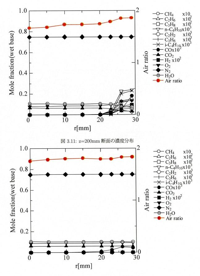
図 3.12: z=350mm 断面の濃度分布
