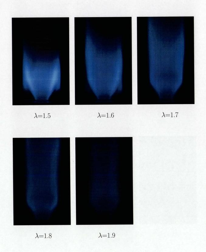
図 2.12: 火炎の直接写真  $(Q_f=10[Nl/min])$
