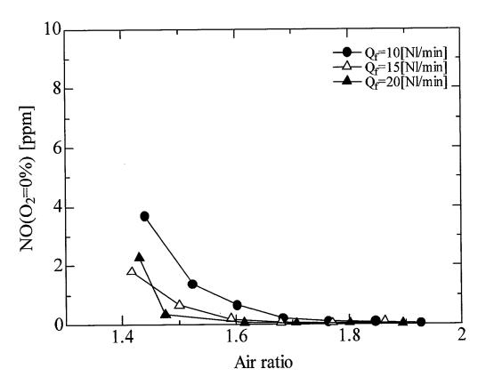
図 2.35: 完全予混合燃焼器における NO 排出濃度 (燃料:CH<sub>4</sub>)
