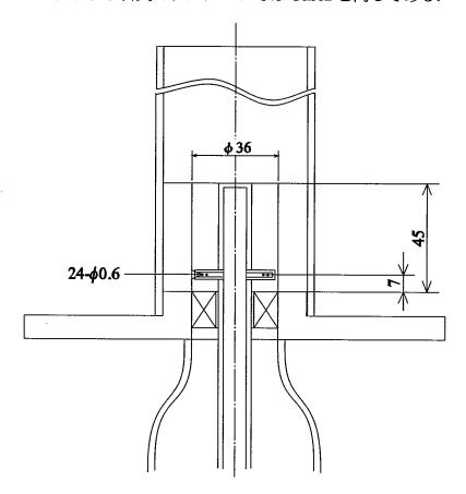
図 2.17: Case3 燃焼器の概略図
