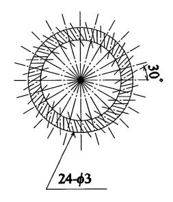
図 2.26: Case4 燃焼器の燃料ノズル
