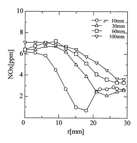
図 3.7: NOx 濃度の半径方向分布
