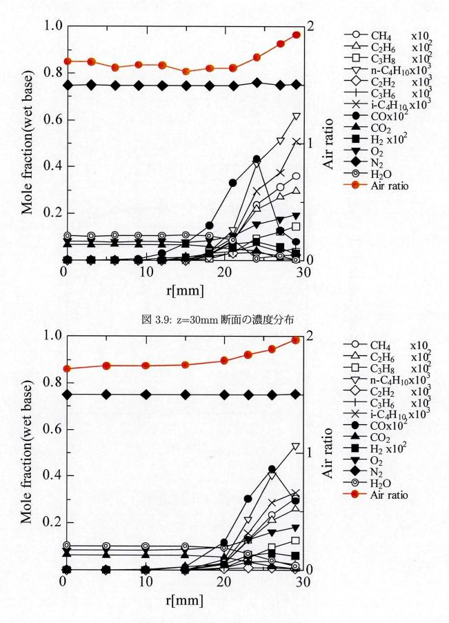
図 3.10: z=100mm 断面の濃度分布
