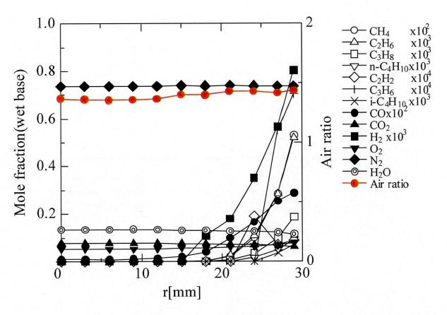
図 3.5: z=60mm 断面の濃度分布
