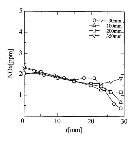
図 3.13: NOx 濃度の半径方向分布
