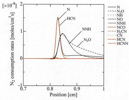
図 5.15: N<sub>2</sub> 分解速度 (λ=1.5)
