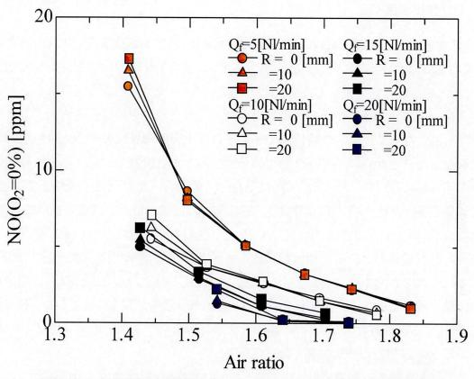
図 2.41: 完全予混合燃焼器 (スワーラなし) における NO 排出濃度
