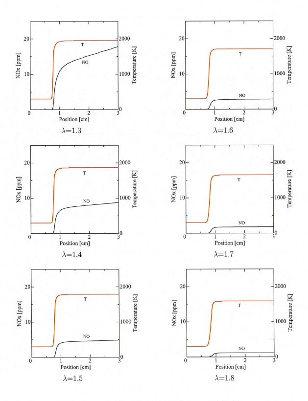
図 5.10: NOx および温度分布 (黒線:NO, 赤線:温度)
