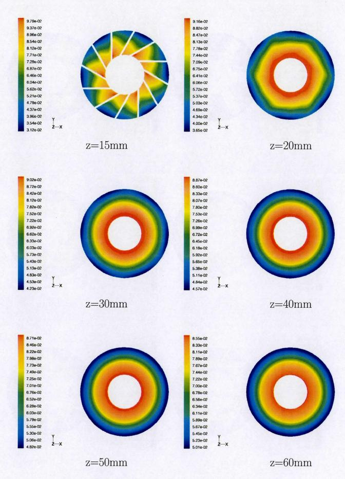
図 4.5: 各断面におけるメタンのモル分率の分布 (z=15~60mm)
