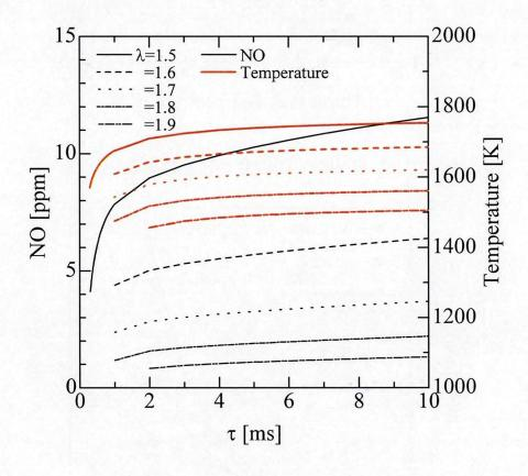
図 5.24: Stirred Reactor での NO 生成
