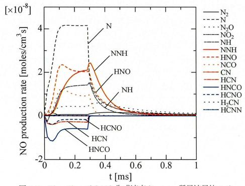
図 5.27: Plug Flow での NO 生成速度 ( $\lambda$ =1.5, 質量流量比 5:5)
