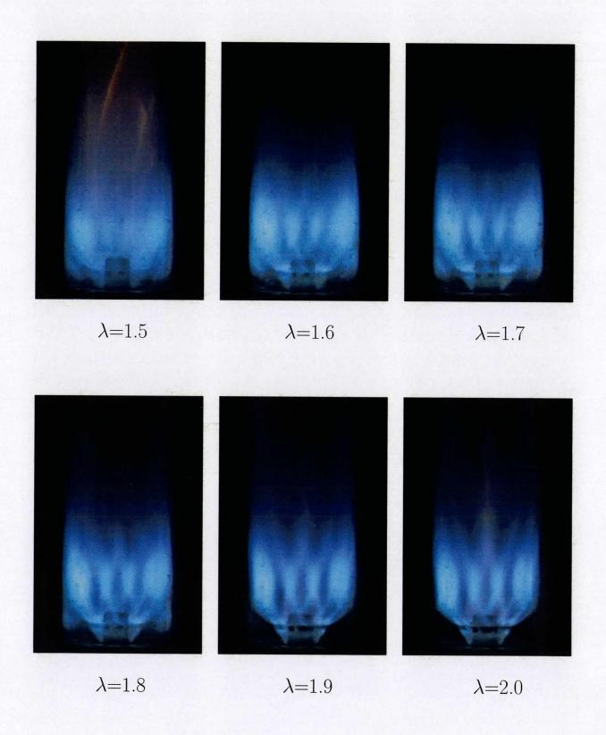
図 2.4: 火炎の直接写真  $(Q_f=10[Nl/min])$
