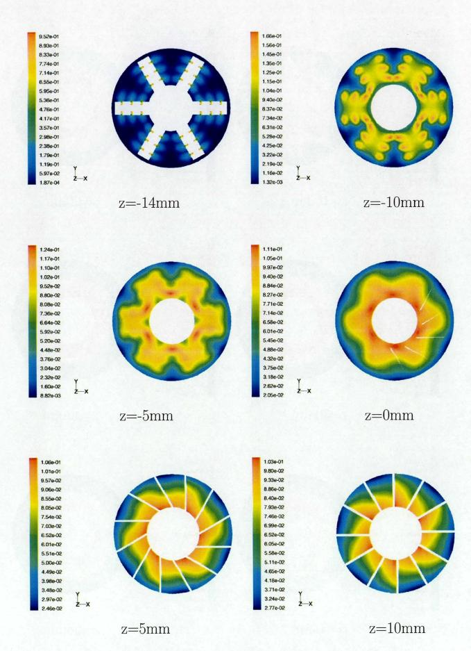
図 4.4: 各断面におけるメタンのモル分率の分布 (z=-14 から 10mm)
