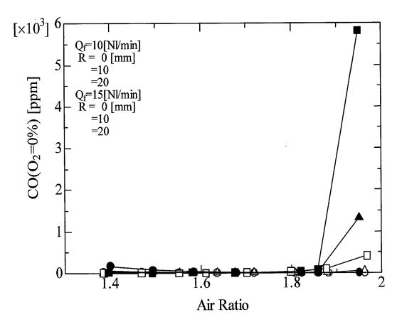
図 2.21: Case3 における CO 排出濃度 (中心側の噴射孔を閉じない場合)
