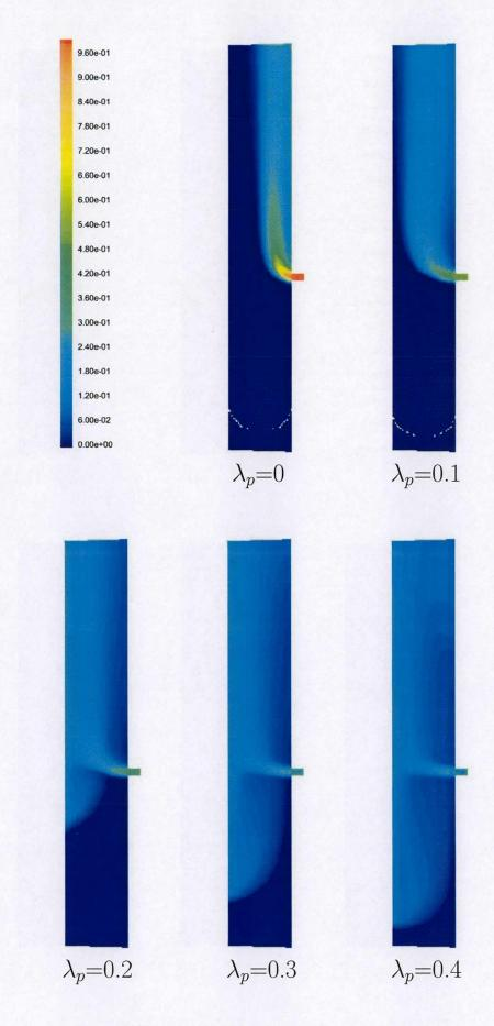
図 4.16: 燃料の混合状況 ( $Q_f=15[Nl/min]$ ,  $\lambda=1.5$ )
