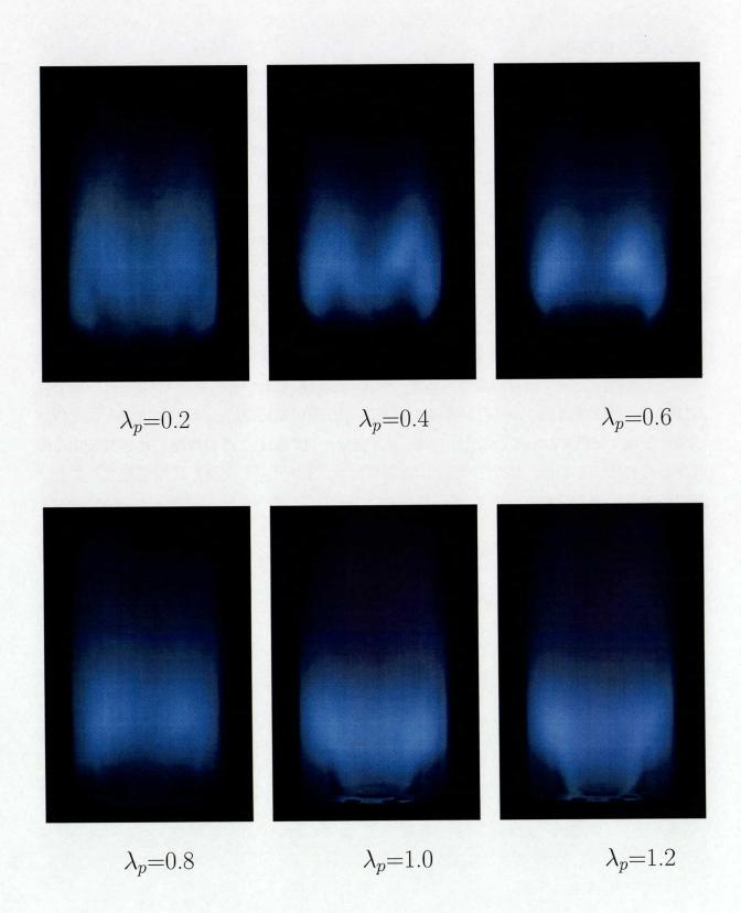
図 2.27: 火炎の直接写真 ( $Q_f=10[Nl/min]$ ,  $\lambda_t=1.63$ )
