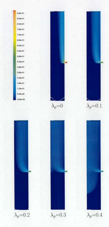
図 4.15: 燃料の混合状況 ( $Q_f=10[Nl/min]$ ,  $\lambda=1.8$ )
