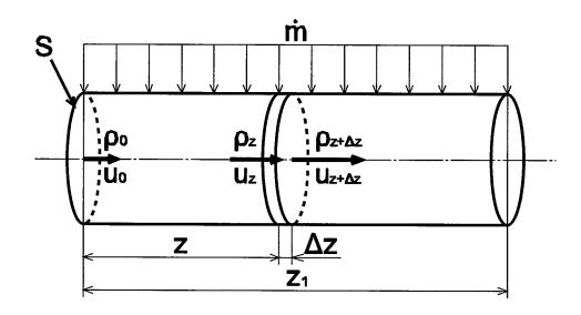
図 5.2: Plug Flow の模式図
