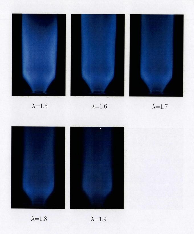
図 2.13: 火炎の直接写真  $(Q_f=20[Nl/min])$
