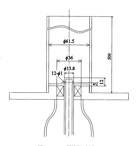
図 2.3: Case1 燃焼器の概略図
