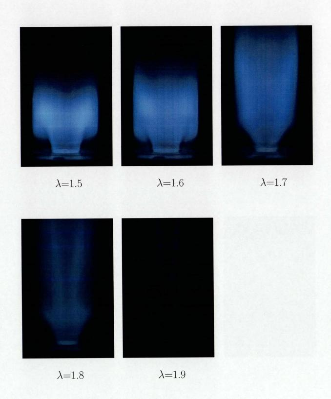
図 2.39: 火炎の直接写真  $(Q_f=10[Nl/min])$
