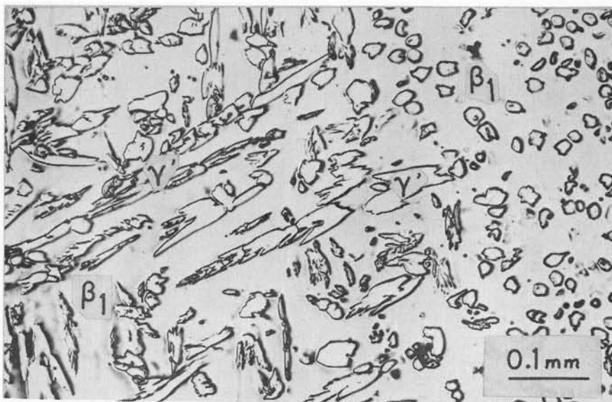
第 2-5 図: 63.8\text{ Ni}-1\text{Co}-\text{Al} 合金の徐冷組織。其地は \beta_1 相、棒状あるいは丸い粒は \gamma' 相。
