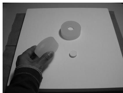
図 2 石膏板とシリコンゴム製の型による成形
