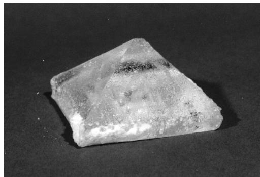
図 5.25 53 mm/day で高速成長した KDP 結晶  $52 \times 52 \times 31$  mm
