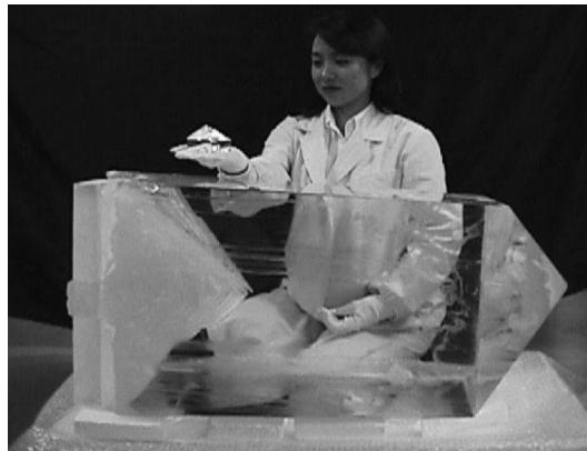
図 5.15 温度降下法により育成された大型 KDP 結晶の写真
