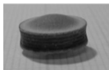
図 7.1 脱脂処理を行わずに焼結した例 (No-dope YAG)
