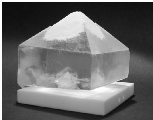
図 5.46 自動育成で得られた KDP 結晶 ( $66 \times 60 \times 40$  mm)
