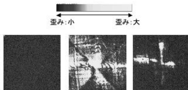
図 5.35 クロスニコル法による結晶内歪みの観察結果
