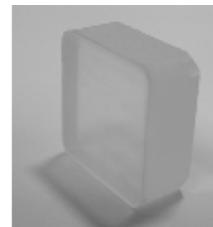
図 8.8 熱アニールによって着色が消えたセラミック
