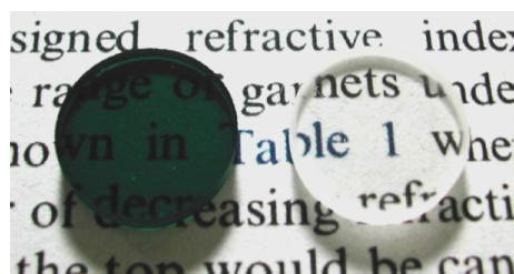
図3.13 热アニール前（左）と後（右）のYb:YAGセラミック
