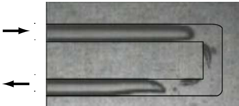
図 4.2(e) 屈曲管における特徴的な現象 ( J_G=15.9\text{m/s} , J_L=0.417\text{ m/s} )
