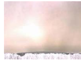
(iii) 親水処理後 ( \theta < 5^\circ )
