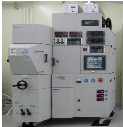
(a)スパッタ成膜装置(芝浦メカトロニクス)
