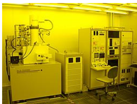
図 2.18 電子線描画装置：エリオニクス (ELS-7000)
