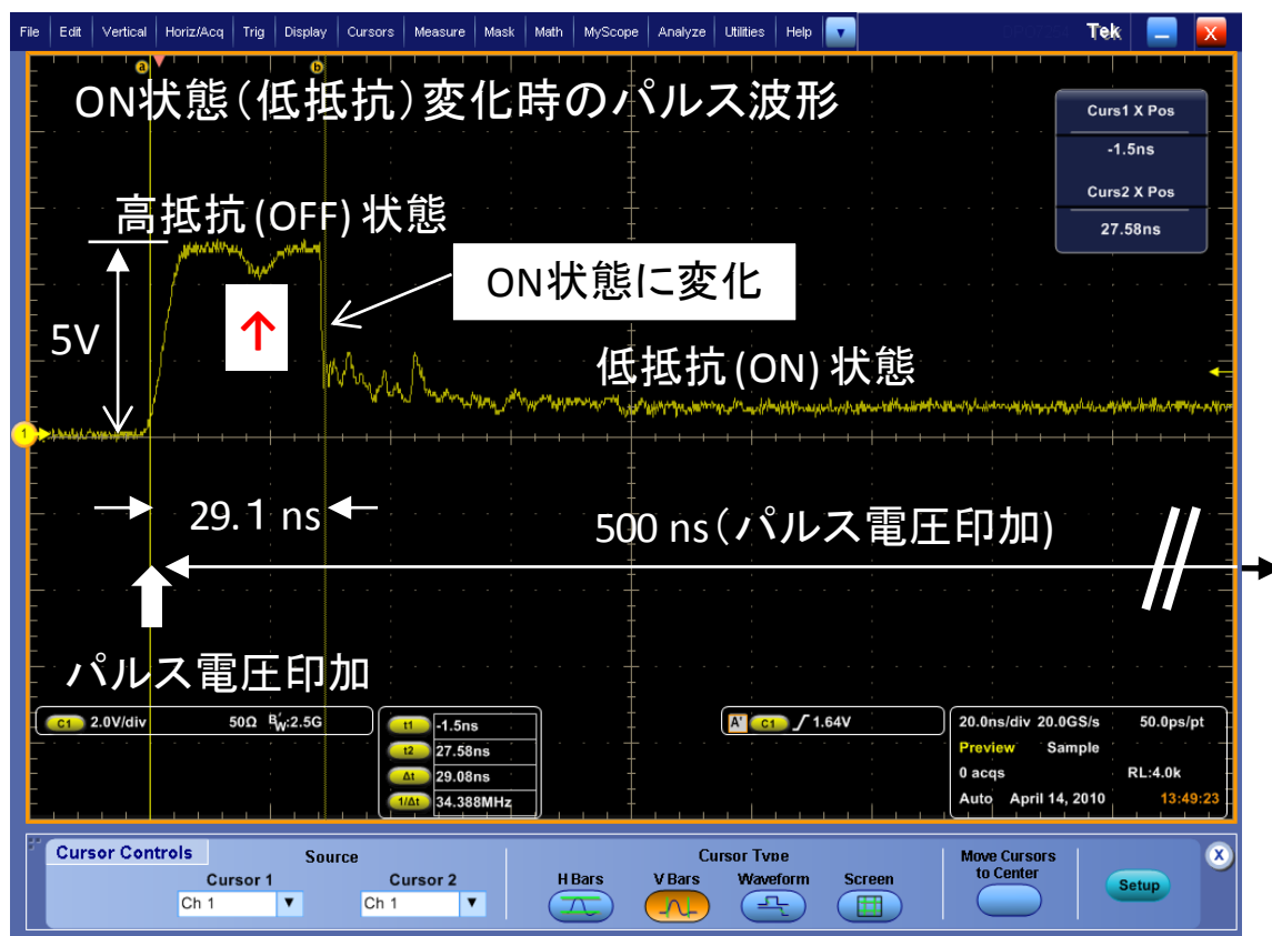
図 3.10 アルミ陽極酸化による AlOx 膜を用いた AlOx-ReRAM の応答速度
