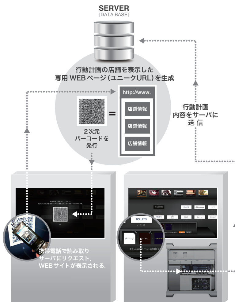
図 3.7: 提案システムのネットワーク構成
