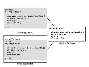
図 1 コードクローン集約の例
